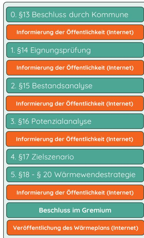
Abbildung 2: Ablauf einer Wärmeplanung nach § 13 WPG
